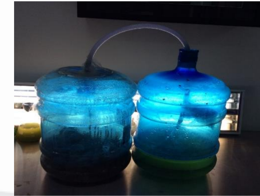
Imagem 23: fotobiorreator acoplado a um biodigestor Fonte: Autor
