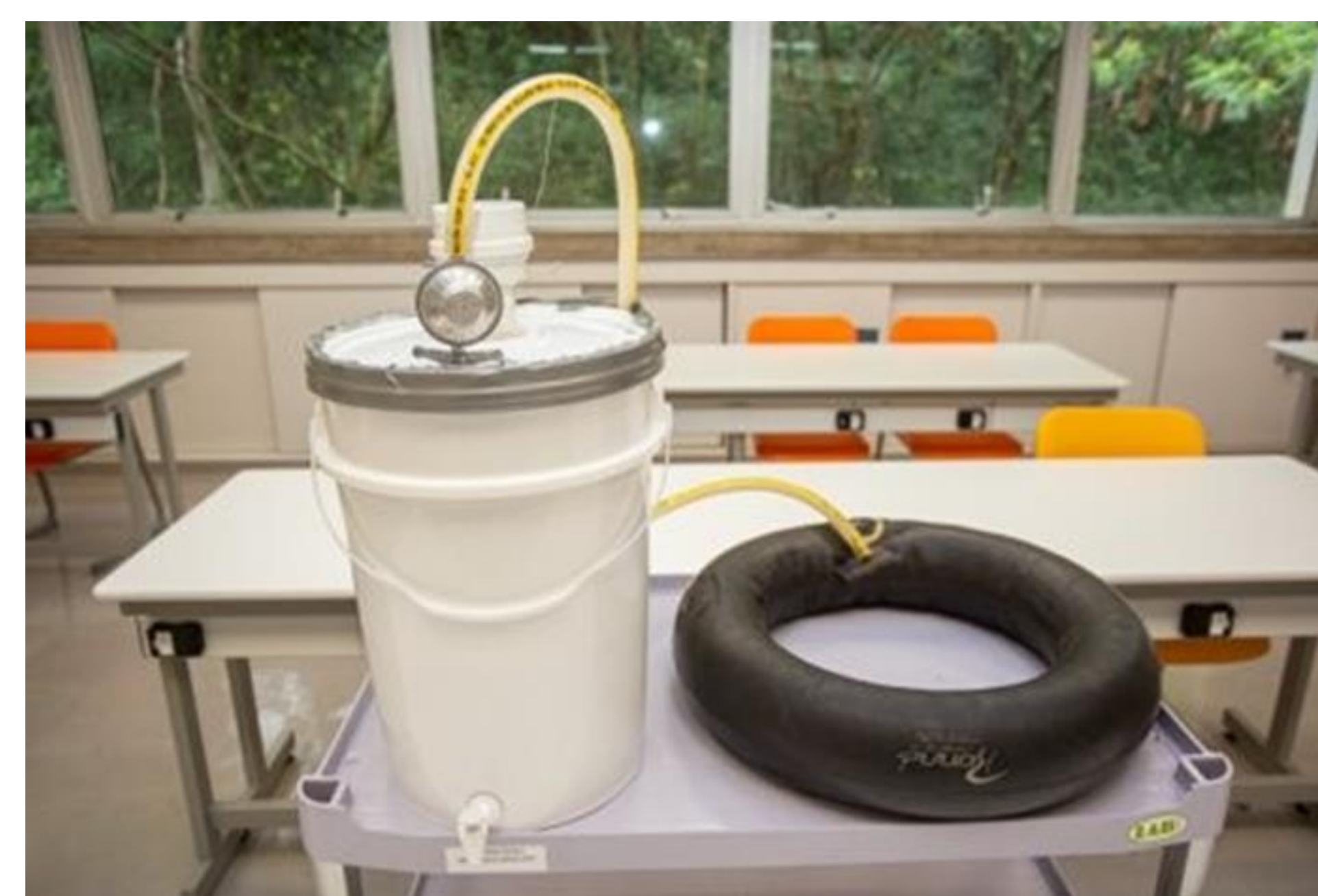
Figura 2. Segundo biodigestor com câmara de pneu cheia de biogás. Fonte: autoral.
