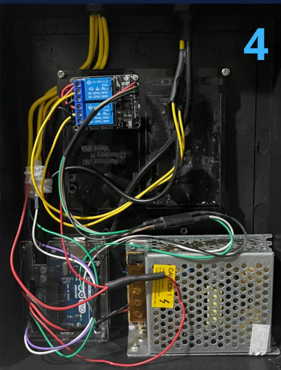
Na figura 4 podemos ver o sistema de controle da estrutura. Ele é composto por um Arduino, uma fonte de 12 Volts, e um modulo de relés. Esse sistema recebe a informação de sensores de luz posicionados ao lado das painéis com o objetivo de determinar o sentido em que devem girar, maximizando a captação de energia fotovoltaica..
