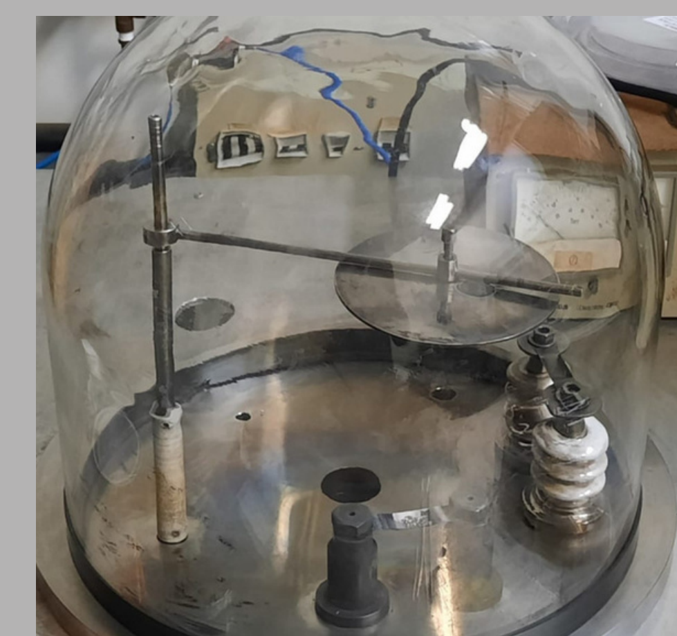
Câmara térmica para deposição. Fonte: arquivo pessoal
