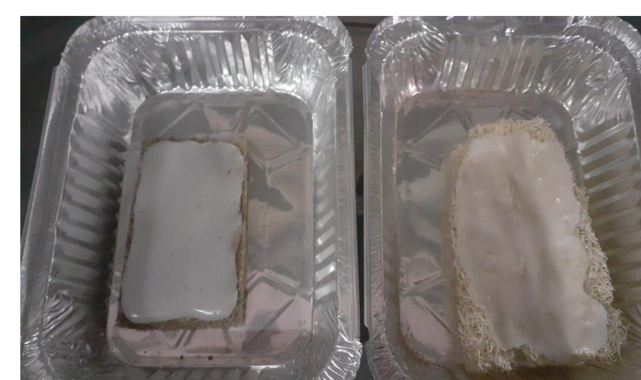
Figura 2 – Mistura obtida do isopor com acetona pura nas fibras.
