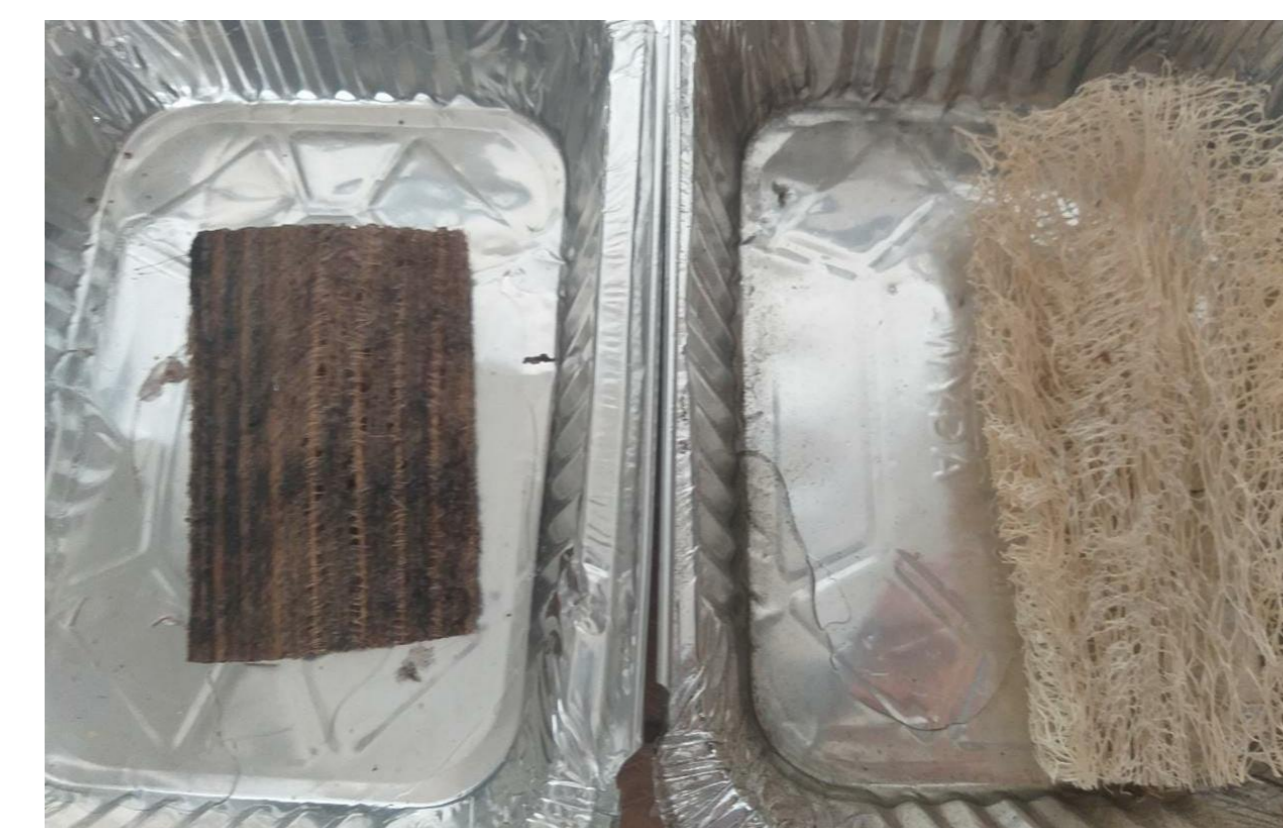
Figura 3 – Mistura obtida do isopor com thinner nas fibras.
