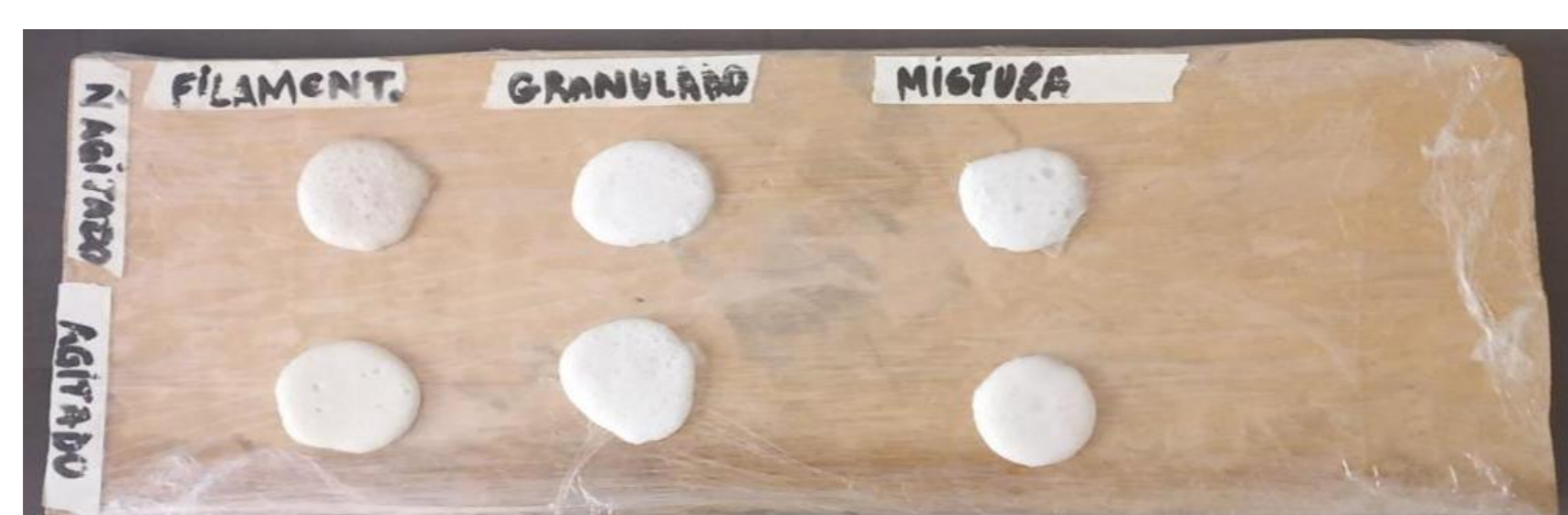
Figura 1 – Mistura obtida do isopor com acetona pura.
