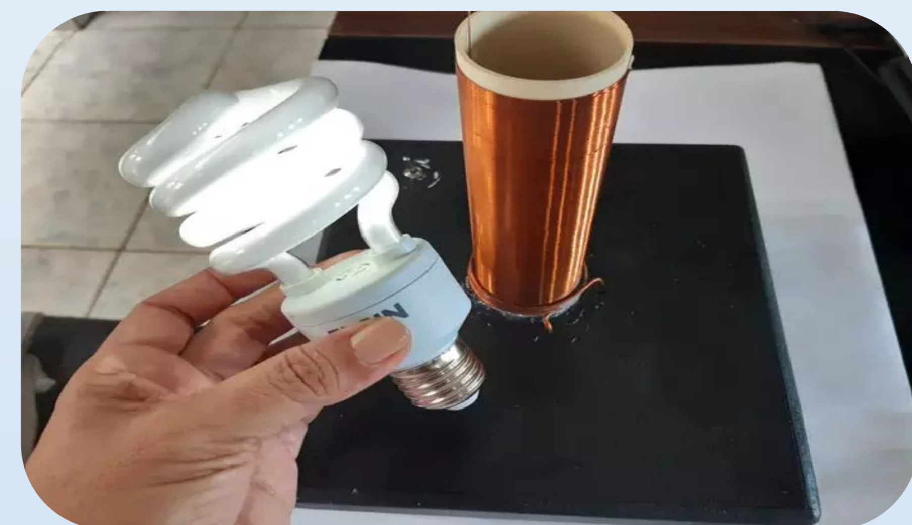
Funcionamento da Bobina de Tesla. Fonte: acervo do autor
