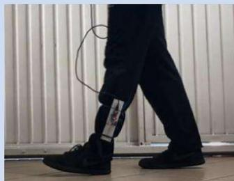
Segunda montagem: Arduino, sensor MPU 6050 e led. Após os valores do sensor obtidos no primeiro teste, a programação foi feita. O led simboliza o eletroestimulador e no momento desejado, ou seja, quando a perna fizesse o movimento para dar um passo, ele era acionado.
