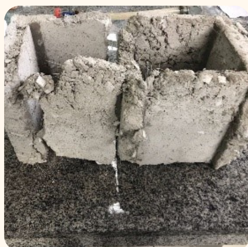
Figura 3- 3º Protótipo após dificuldades ao desenformar
