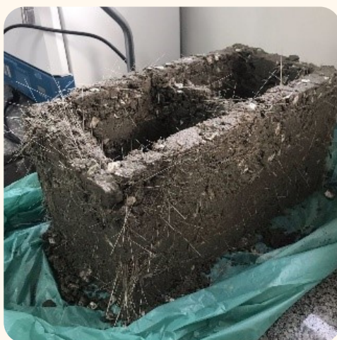
Figura 2- 2º Protótipo com fibra e isopor
