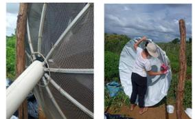
As antenas parabólicas foram revestidas com lona e tiveram um espaço aberto para a passagem de um cano PVC.
