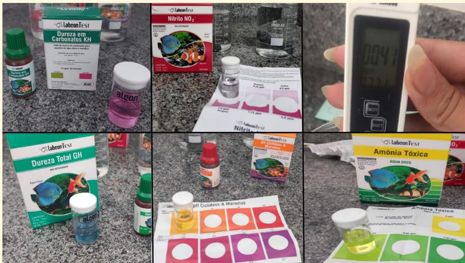
Testes de potabilidade da água, com medidores de ph, temperatura, nitrito NO<sub>2</sub>, amônia tóxica, pH, ciclídeos e marinhos, dureza total GH, dureza em carbonatos KH.
