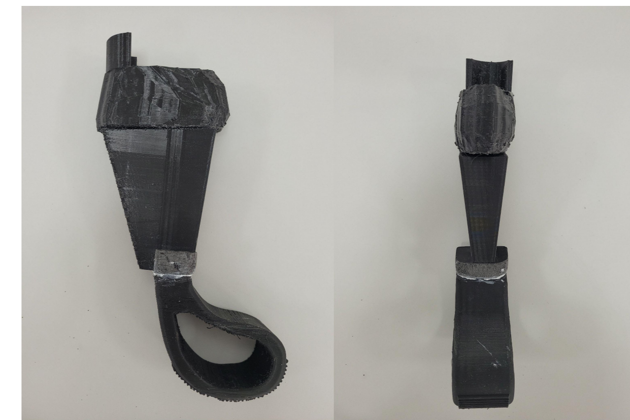
Figura 3 – Prótese canina de membro inferior feita em impressora 3D Fonte: Os autores, 2022.
