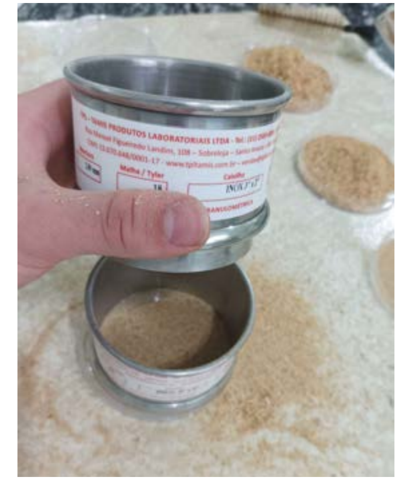
Figura 3. Trituração da casca de batata-doce Figura 4. Processo de tamização dos materiais
