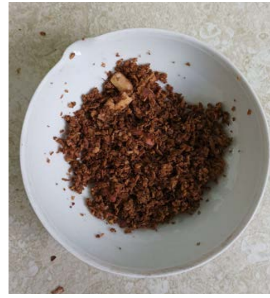
Figura 3. Trituração da casca de batata-doce Figura 4. Processo de tamização dos materiais
