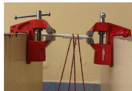
**Figura 4. Teste de elasticidade.** As duas morsa posicionadas de modo a sustentar a amostra. No centro encontra-se o barbante que sustentará os pacotes com massas conhecidas
