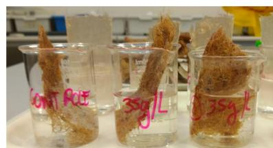
**Figura 1. Amostras do protótipo utilizado na competição FLL.** Juntamente com a resina epóxi, foram feitos retângulos com dimensões aproximadas de 5 cmx10 cm. As amostras foram deixadas dentro de béckeres por 14 dias sendo anotados os resultados.
