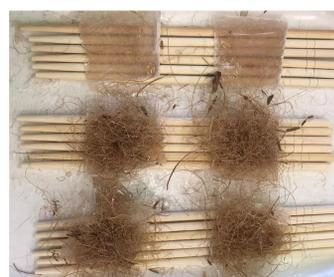
**Figura 3. Experimento 3 com a sustentação do bambu.** Foi feita uma base com *hashis* de bambu para solucionar o vazamento de resina e melhorar padronizar a estrutura formada.
