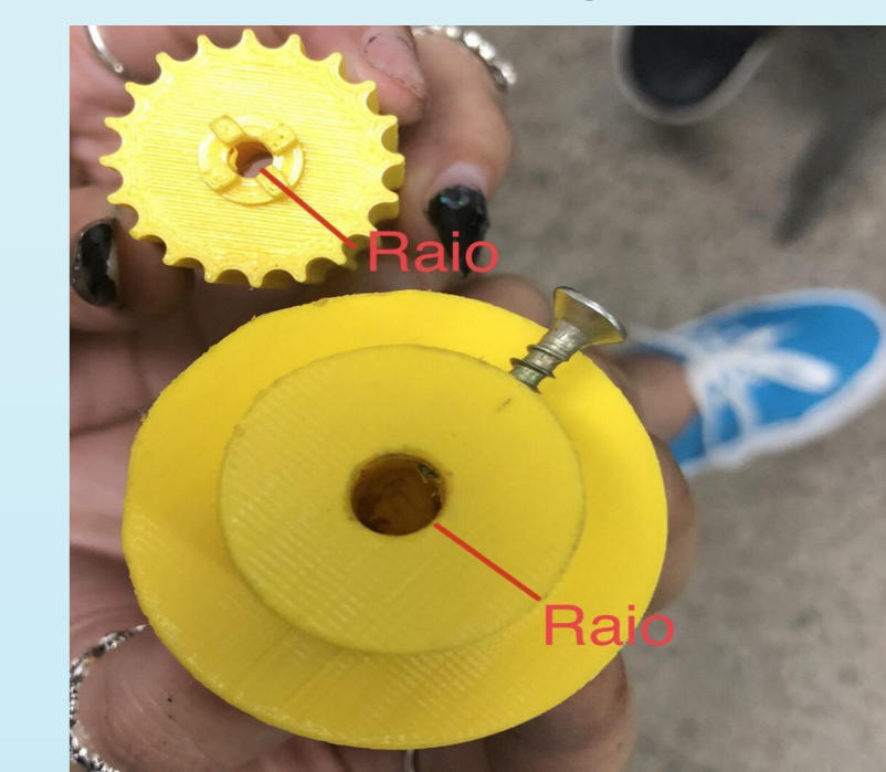
Figura 14 - Engrenagem usada a fim de diminuir a alavanca. (Foto tirada pelo grupo)
