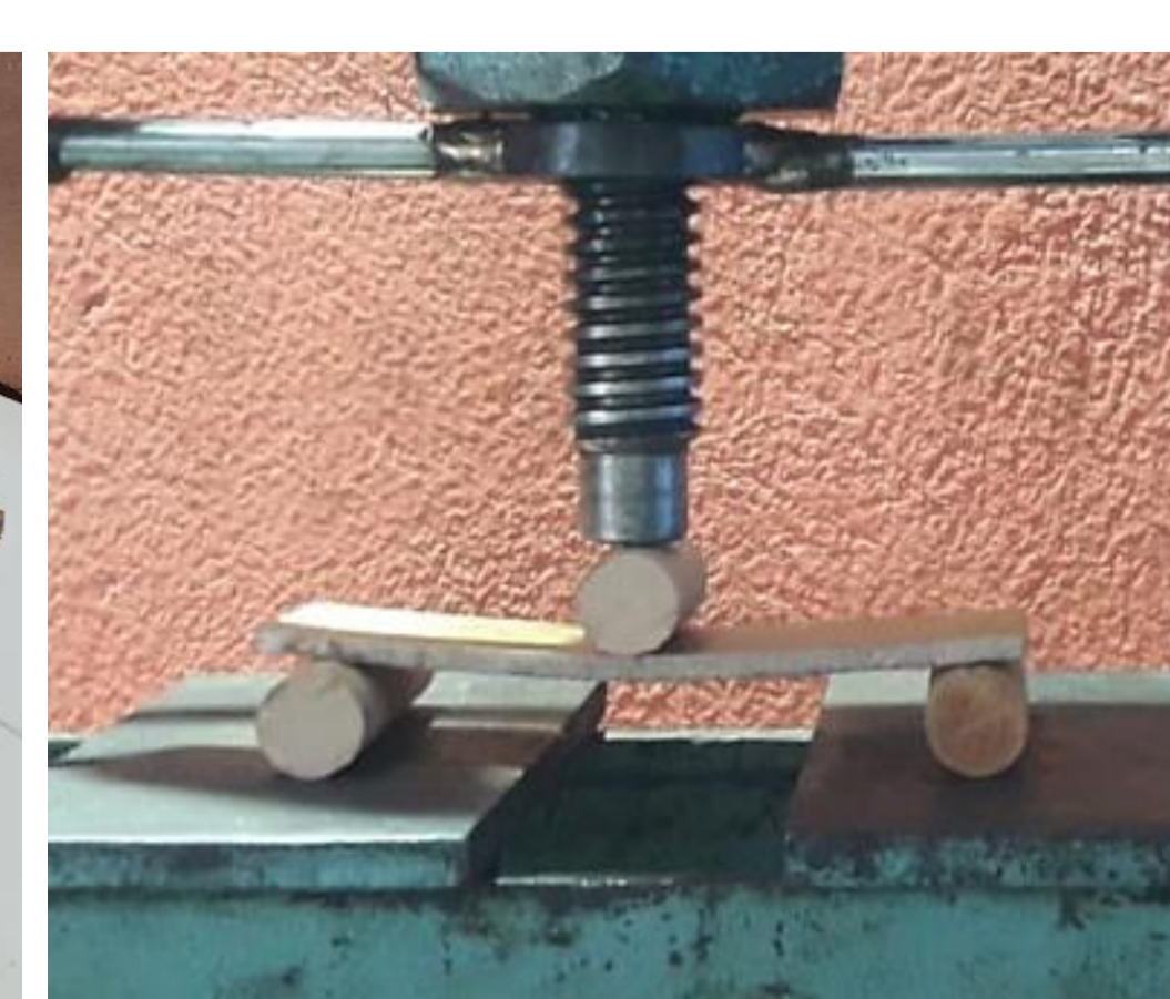
2022: MOURA Figura 12: realização do ensaio de resistência
