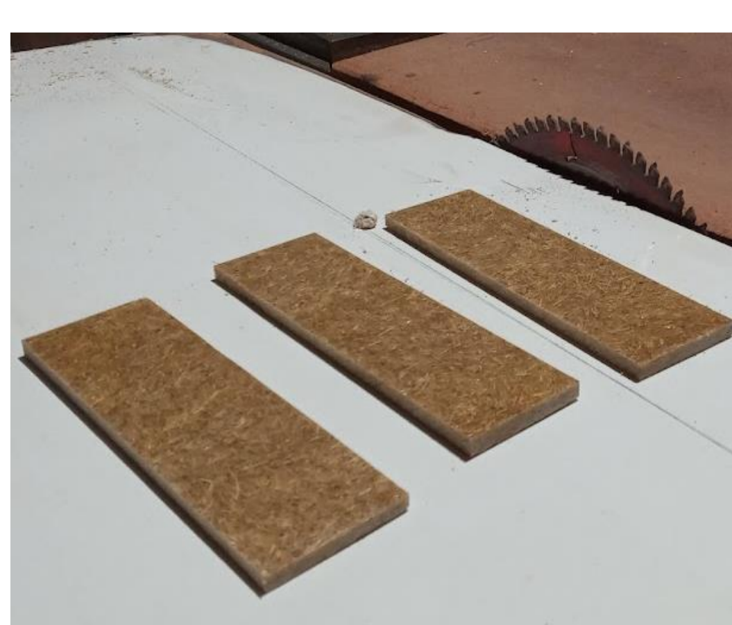
2022: SILVEIRA Figura 11: Preparação dos corpos de prova
