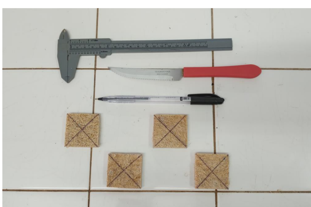
2022: MOURA Figura 09: Preparação dos corpos de prova
