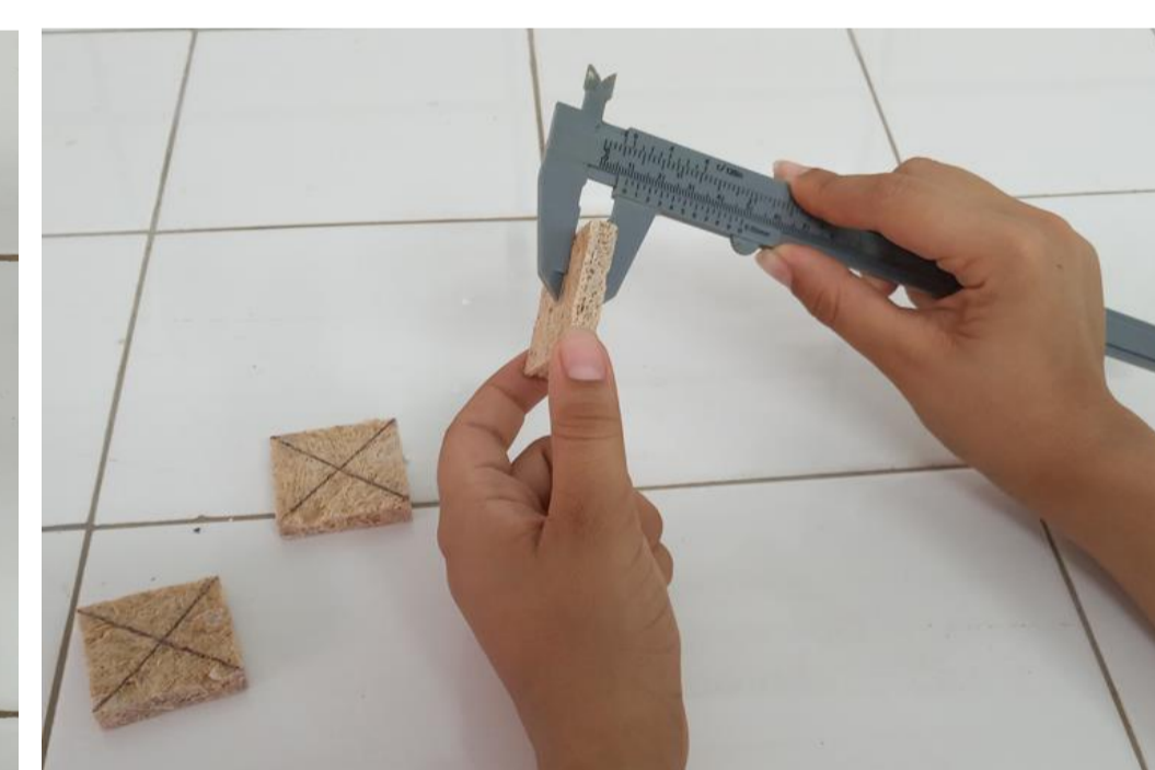
2022: MOURA Figura 10: Aferição das dimensões das placas
