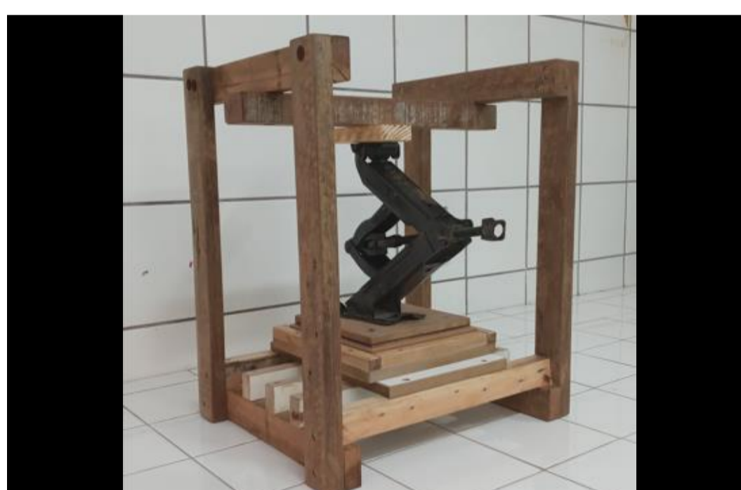
2022: MOURA Figura 07: Prensaagem do PC Board
