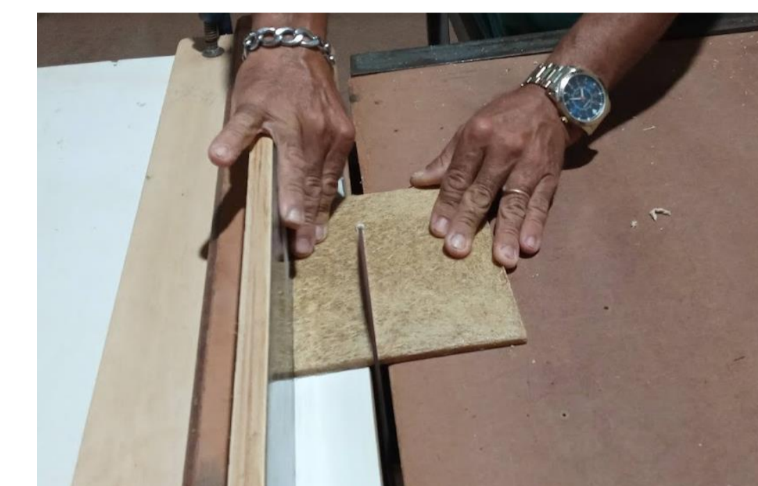
2022: SILVEIRA Figura 15: Corte das placas de PC Board em uma moveleira
