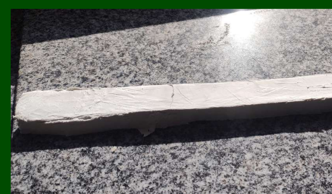
Figura 5.6: Retirada do silicone; Fonte: Autores.
