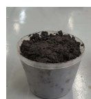
Amostra de lodo após passar pelo processo de biossecagem
