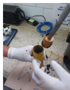
Confeção dos briquetes usando molde cilíndrico (4cm x 25cm) e soquete para compactação
