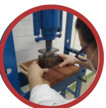
Prensagem dos corpos de prova
