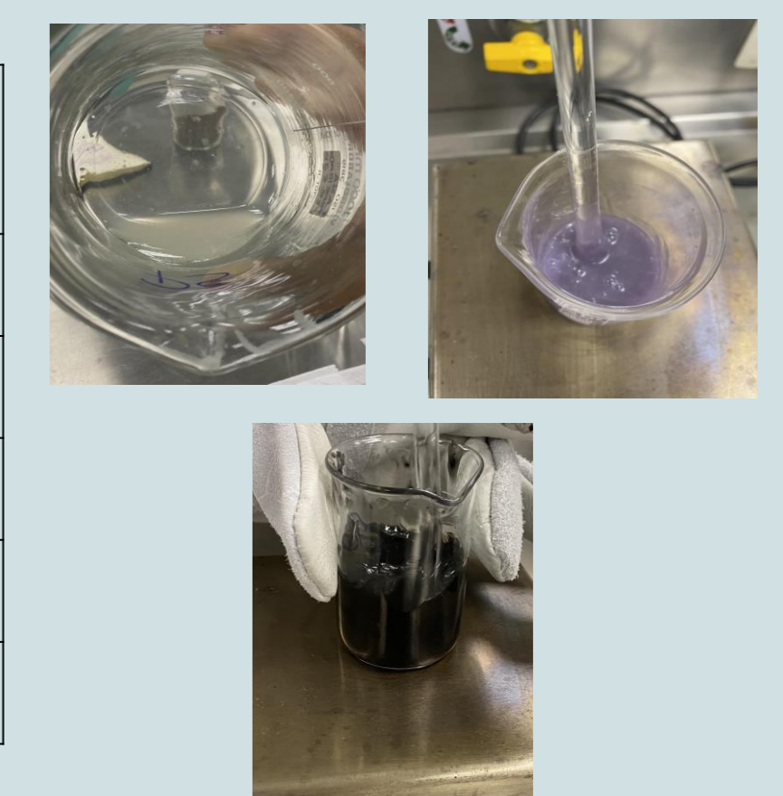
FIGURA 10: Aspecto dos produtos resultantes do contato de limoneno com os plásticos. Fonte: Autoria própria.
