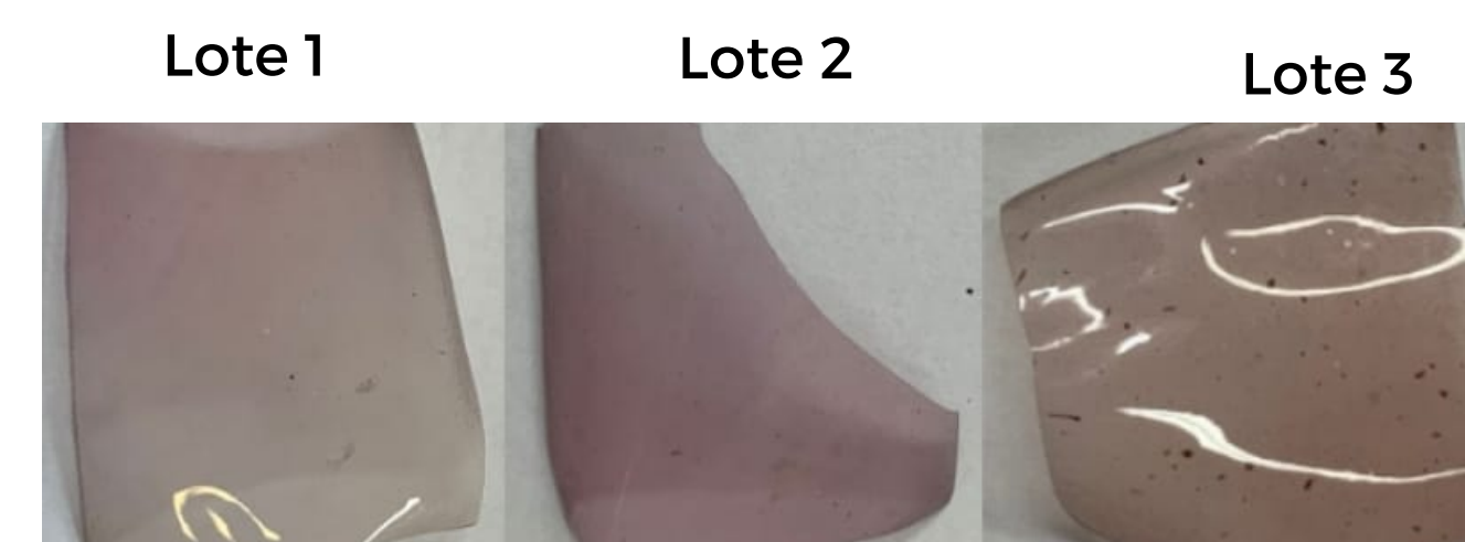
Figura 2: aspecto do filme posto em contato com hidróxido de amônio.
