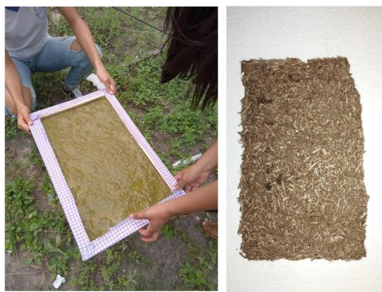
Figura 3. Preparação da tela com a polpa de palha verde e resultado final. (FONTE: Arquivo dos autores do projeto.)
