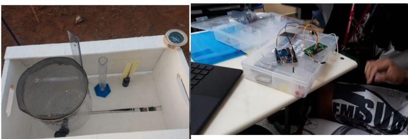
Figuras 1 e 2 – Montagem da Estação Meteorológica Experimental e Automatização utilizando arduino.
