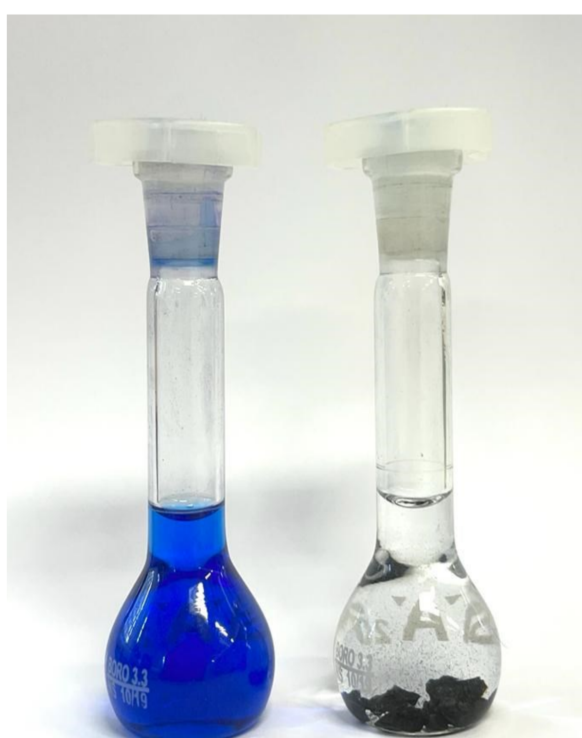
Imagem 05: Teste qualitativo de adsorção FONTE: Autores (2022)
