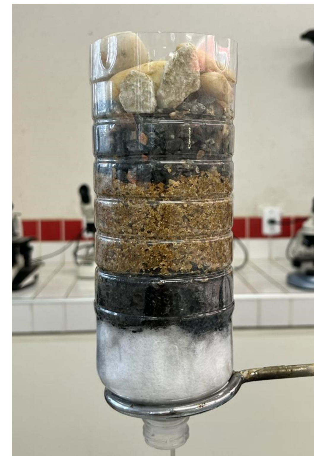
Imagem 06: Protótipo de filtro de tratamento FONTE: Autores (2022)
