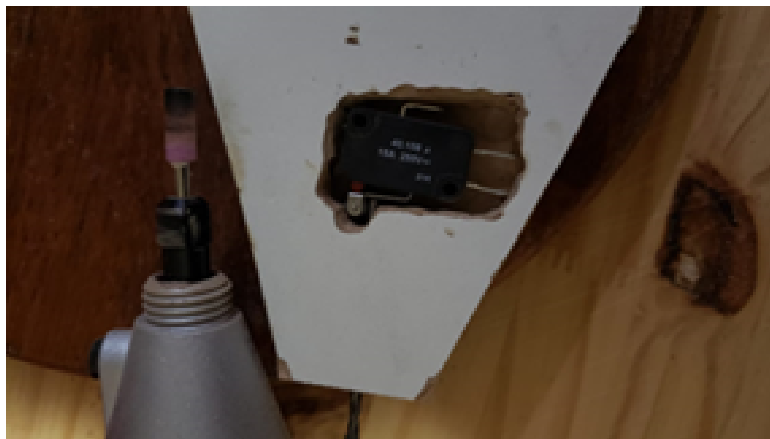
FIGURA 3 – ORIFÍCIO NO MDF COM O FIM DE CURSO ACOPLADO
