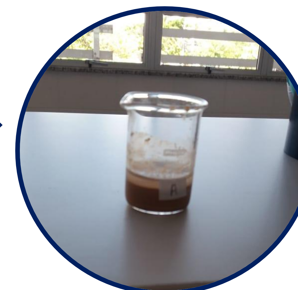
Figura 10: Amostra "A" no processo de medição do pH do solo coletado Fonte: O autor
