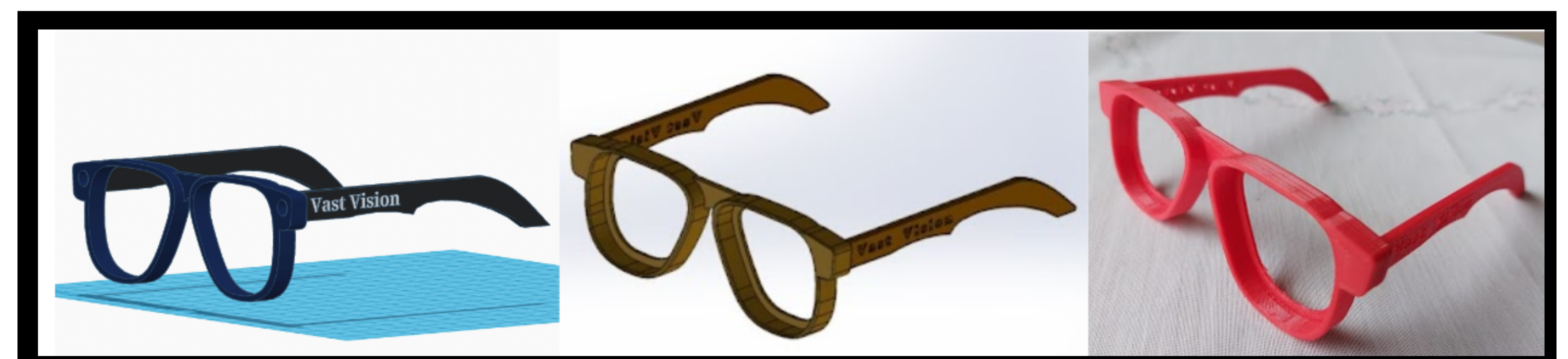
Figura 2: Modelagem e impressão do óculos 3D
