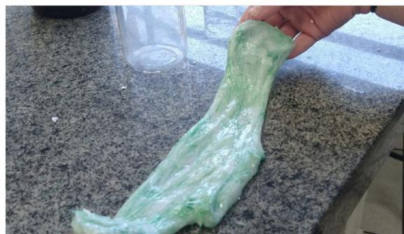
Figura 7: Isopor dissolvido com fibra de vidro
