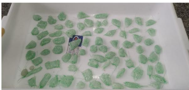
Figura 8: Brita de Isopor e Fibra de vidro
