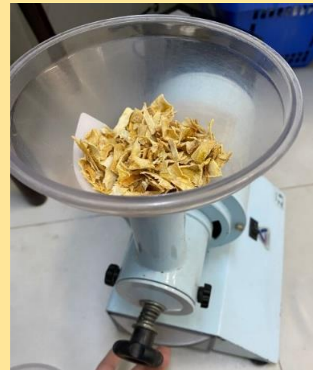
Figura 6 – Moagem do albedo seco Fonte: Autores, 2023.
