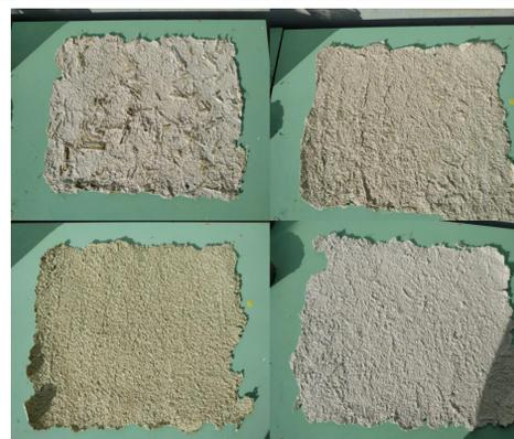
Figura 1 – Análise da textura da mistura após ter secado em tela
