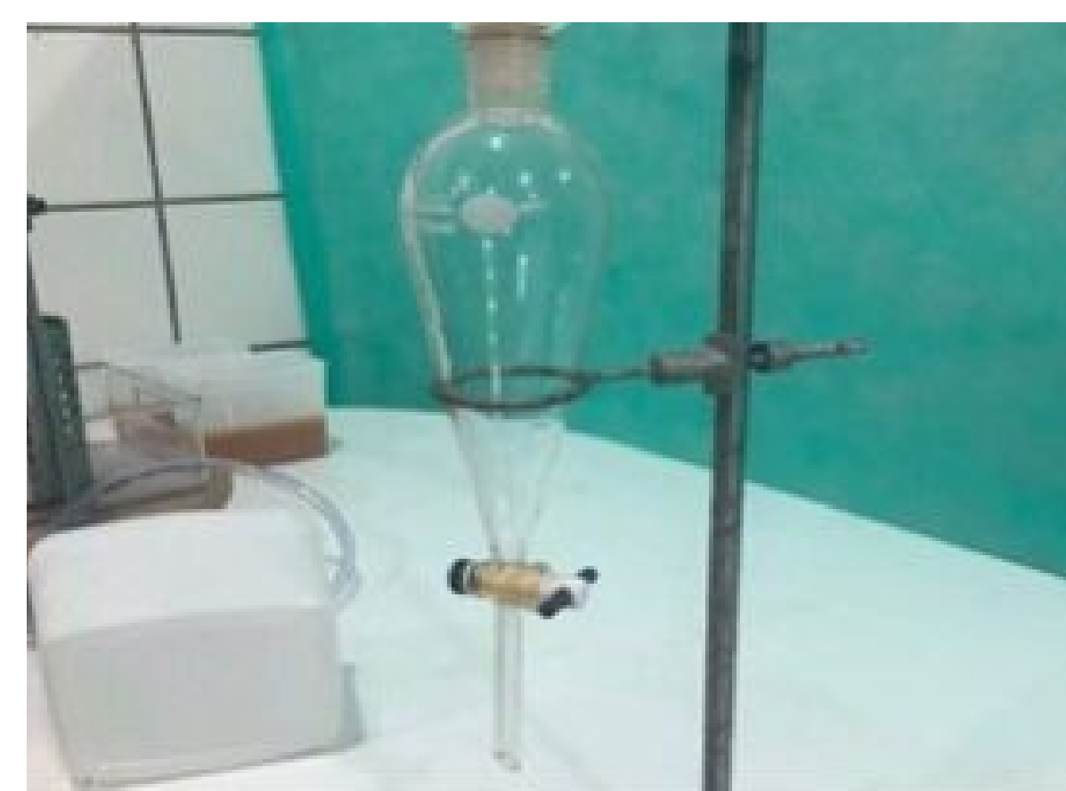
Fonte: As autoras 2024_Imagem 3: Método utilizado para separar o óleo lignocelulósico de outros componentes.
