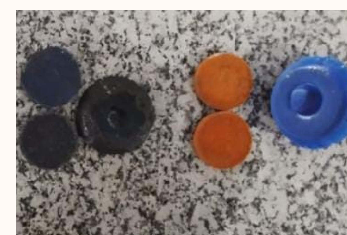
Figura 3. Moldes confeccionados na estufa a 210° C durante 10 minutos.
