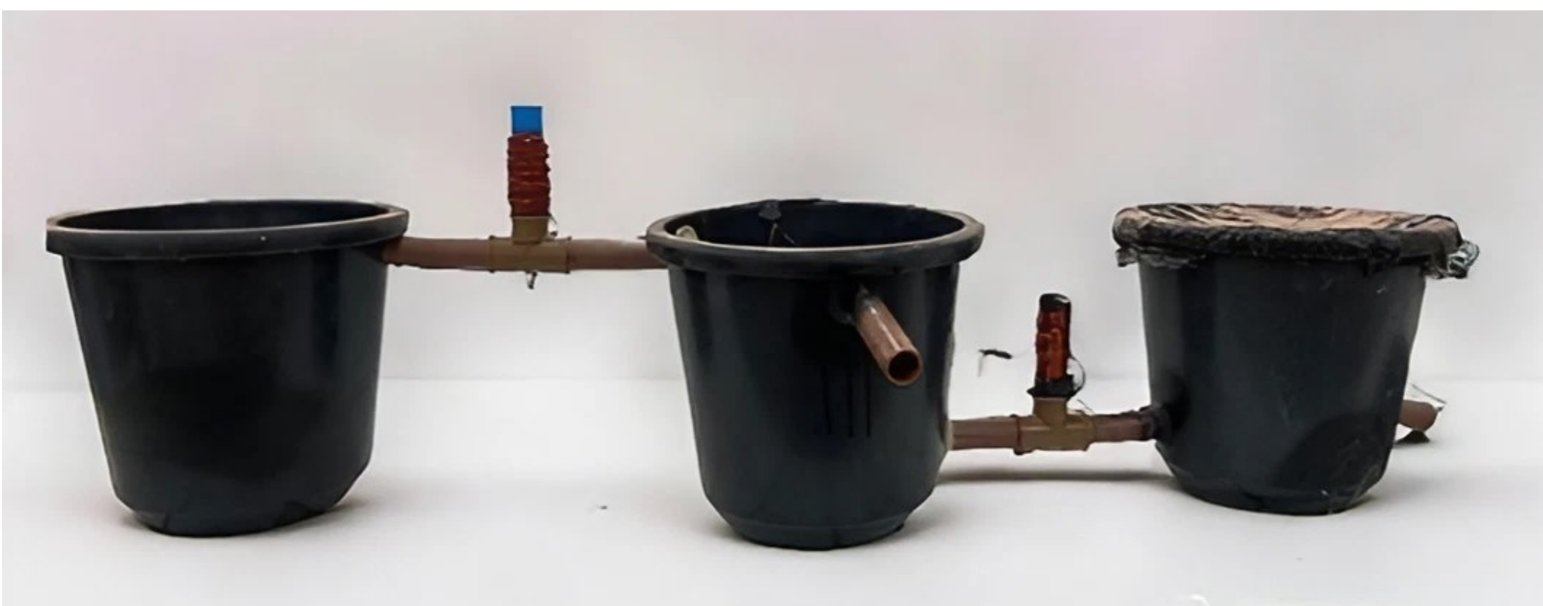
Imagem 01: Sistema automático para tratamento de água residual contaminada produzido. Fonte: Autores (2023).
