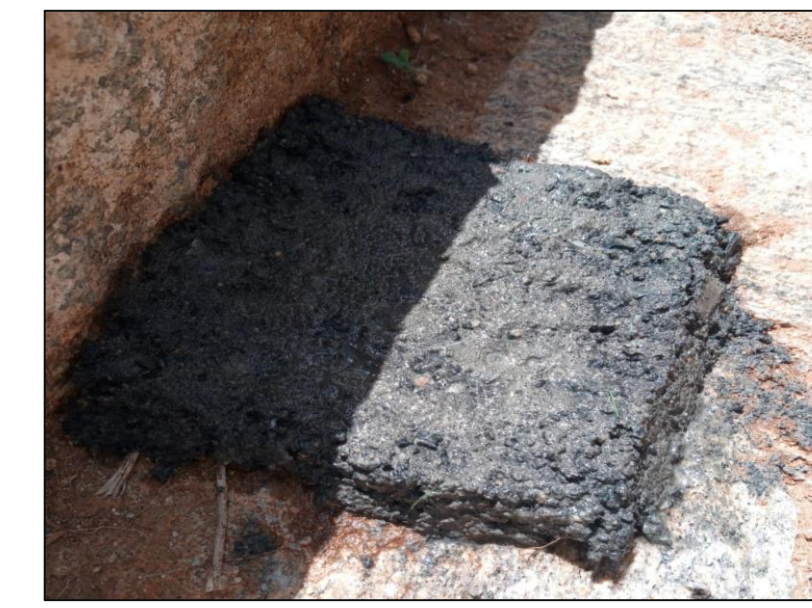
Figura 9 - Processo de modulação dos protótipos do asfalto diretamente na rua. Fonte: Autora (2023)
