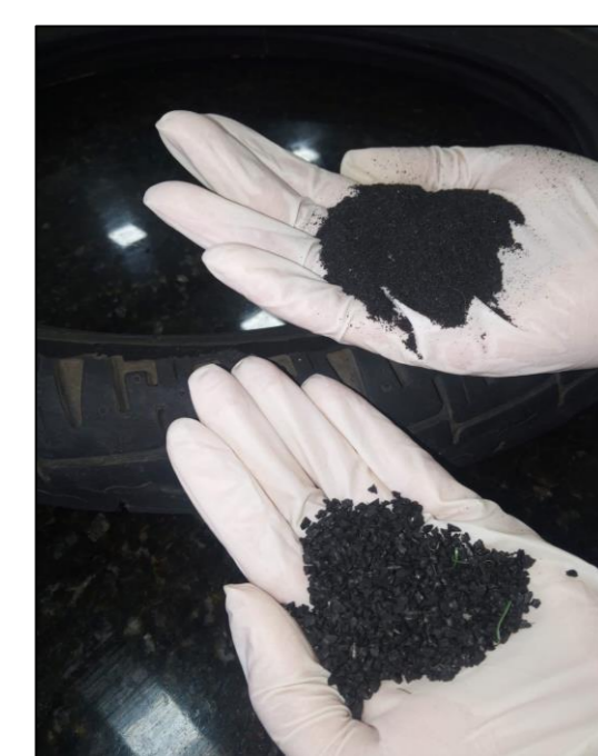
Figura 4 - Moagem e trituração dos invólucros eletrônicos. Fonte: Autora (2023)
