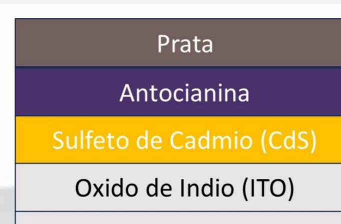
Figura 4: Esquema de uma célula solar - Vidro/ITO/CdS/Silver. Fonte: Autor
