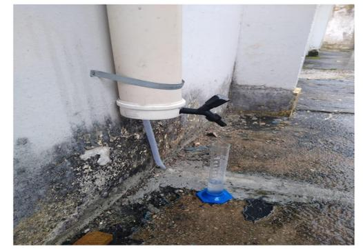
Fig.4 Aferição com proveta graduada - Foto - autores
