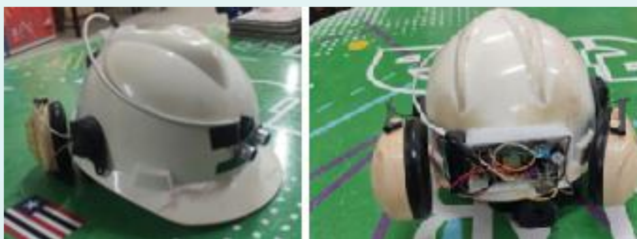
Fig.02 – Protótipo do capacete inteligente dotado de estação de sensores e comunicação wi-fi
