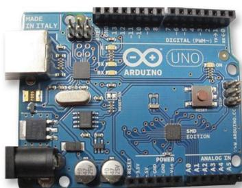
Figura 1. Arduino Uno. (fonte: próprio autor).
