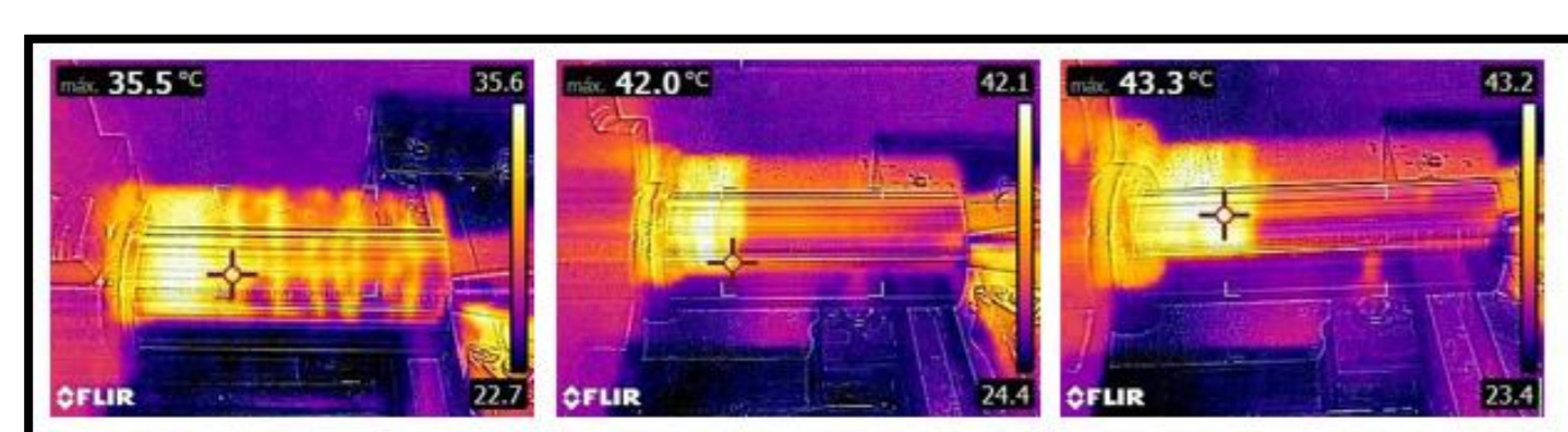
Figura 4: Medição com câmera termográfica fluido comercial (fonte: autores)
