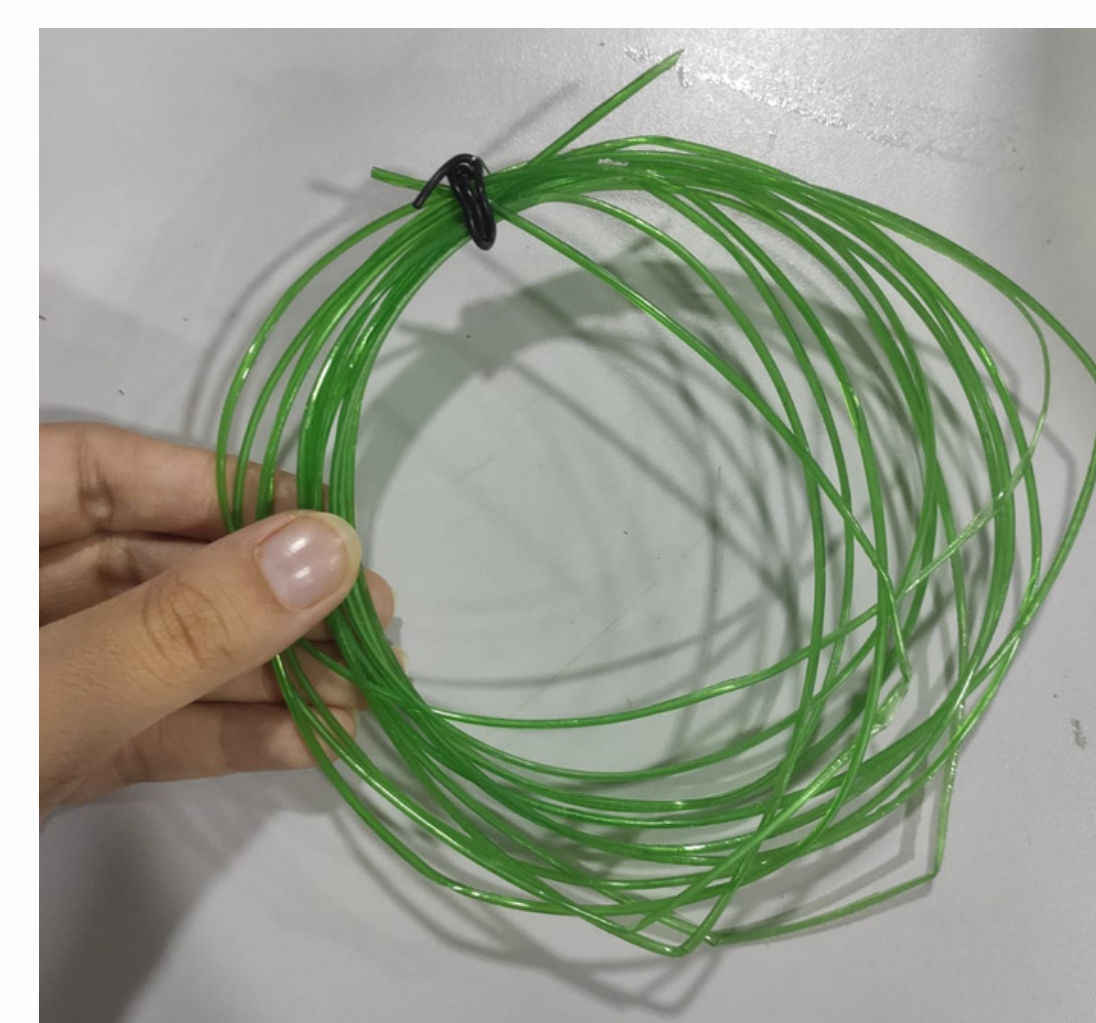
Figura 5 – Filamento produzido tendo como matéria prima o plástico PET reciclado. Fonte: Autores, 2023.
