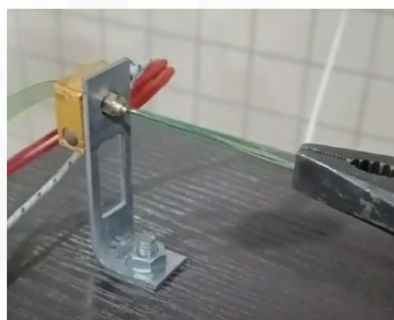
Figura 4 – Filamento sendo produzido pela máquina. Note a entrada do PET na espessura de tira e a saída na forma de filamento pronto para ser utilizado na impressora. Fonte: Autores, 2023.
