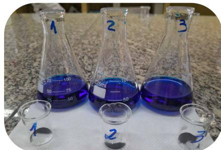
**LOTES 1, 2 E 3:** Parâmetros fixos permaneceram, sem mudança de pH e tempo de contato adsorvato/adsorvente de 45 minutos em agitação.
