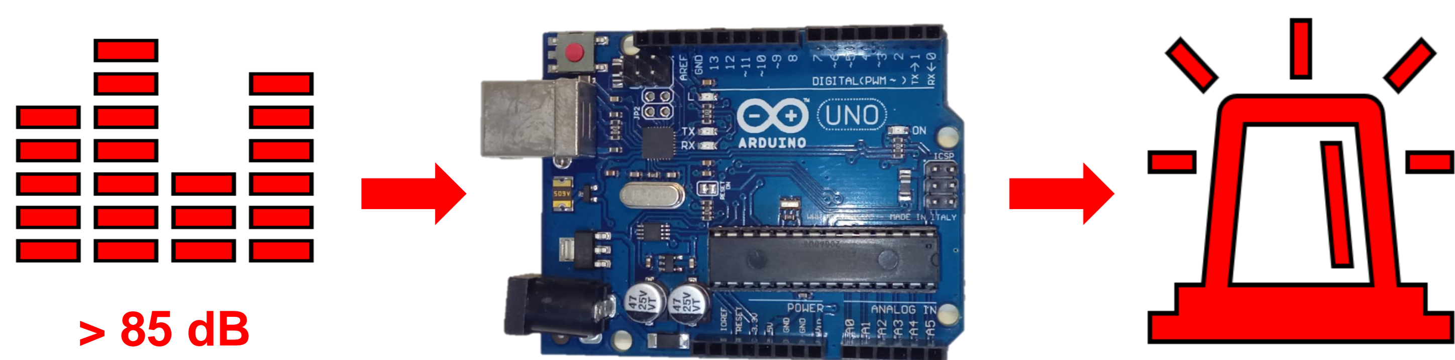
Figura 1 – Fluxograma do funcionamento do dispositivo para controle do nível de ruído. Fonte: Próprio autor, 2023.
