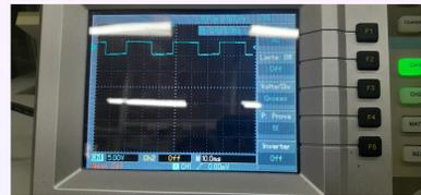
Figura 2. Osciloscópio com o sinal PWM da máscara de solda automática. Fonte: (Arquivo do autor)
