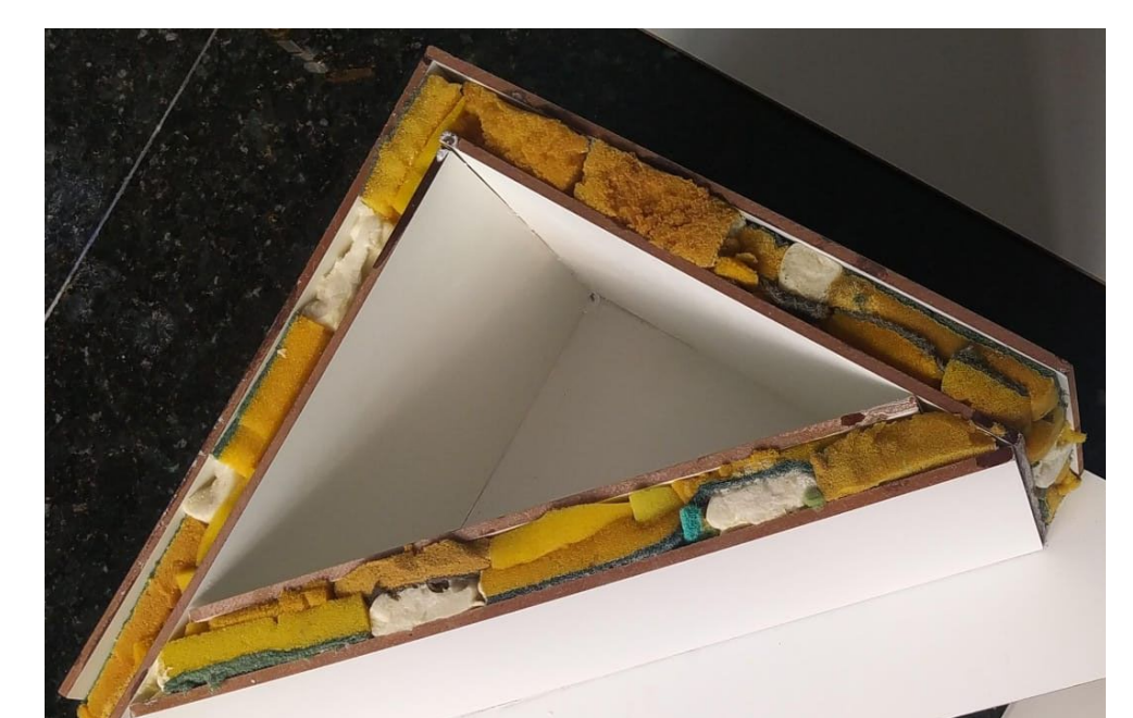
FIGURA 3- Maquete da sala de aula (vista interna)
