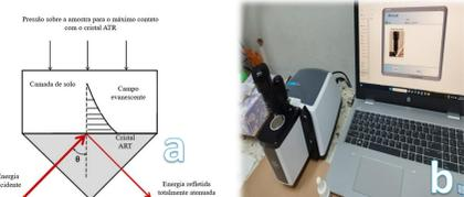
**Figura 4** - Esquema do mecanismo de ATR encontrado em espectrômetros FTIR (a). Fonte: Adaptada de GE et.al. (2014) e Foto realizando experimento (b) Fonte: próprio autor
