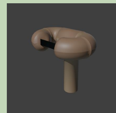
Imagem 16: Modelo 3D do removedor de espinhos, proposta em cano de PVC.
