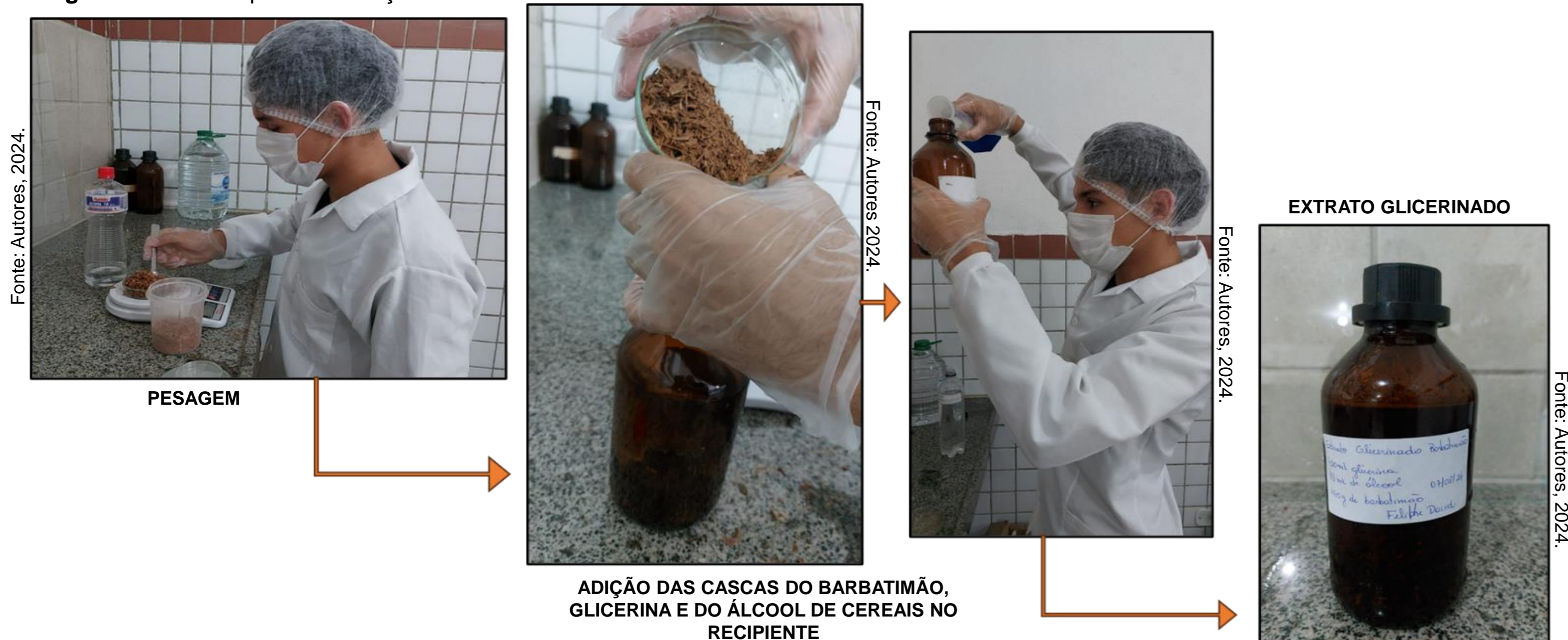
Figura 1. Processo para a obtenção do extrato da casca do barbatimão
