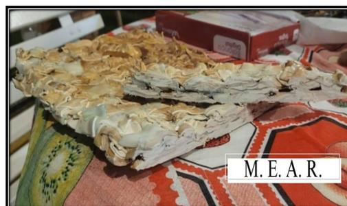
O MEAR (Material Ecológico de Alta Resistência) cria um material inovador combinando aço e polietileno reciclado, com alta resistência mecânica. Ele visa ampliar aplicações na engenharia, promovendo a sustentabilidade e o uso de materiais recicláveis.
