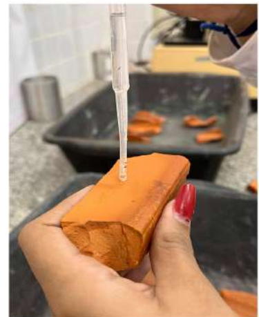
Figura 04 – Teste de absorção por imersão. Fonte: arquivo pessoal
