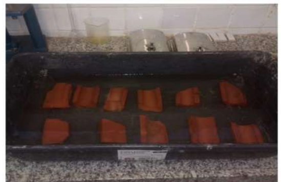
Figura 04 – Teste de absorção por imersão. Fonte: arquivo pessoal
