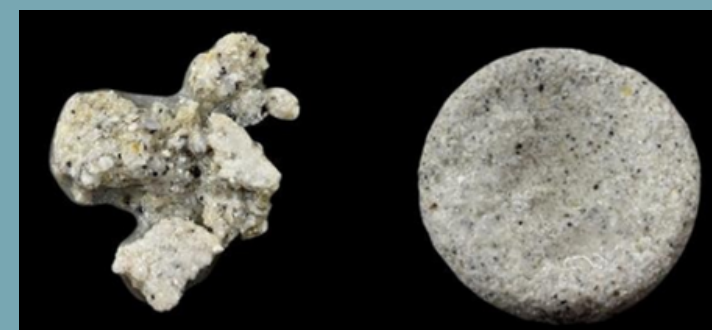
Figura 6. Resultado dos testes realizados com argila branca e ágar ágar; e apenas ágar ágar, respectivamente. Fonte: O autor (2024).
