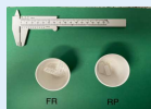
FIGURA 5 - Cadinho com fibra de vidro e resina poliéster (FR) e com resina pura (RP) antes do aquecimento. Fonte: Autoria própria.
